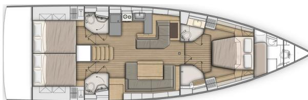
L'arrière cuisine passe à tribord et est remplacée par une salle d'eau.
